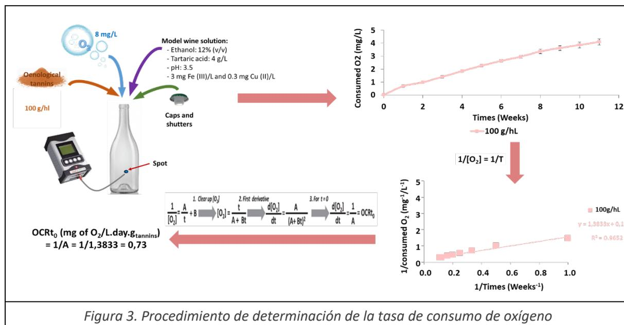
Figura 3. Procedimiento de determinación de la tasa de consumo de oxígeno
