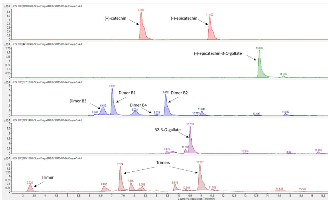
Figura 1. Ejemplo de análisis de procianidinas/prodelphinidinas en los modos ESI y SIM
