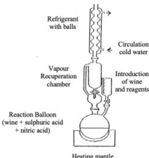
**Figure n°2. Mineralisation apparatus**
