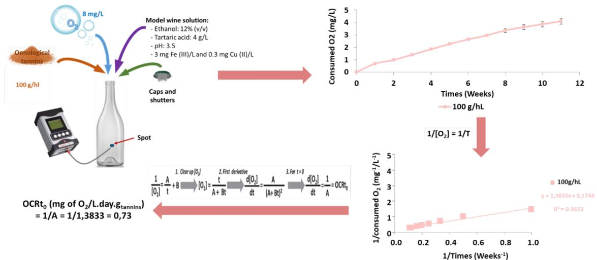
Figura 4: Procedimento per determinare il tasso di consumo di ossigeno
