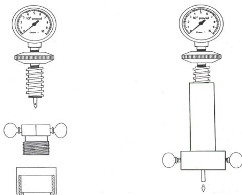
Figure 1 : Aphromètre pour capsules
