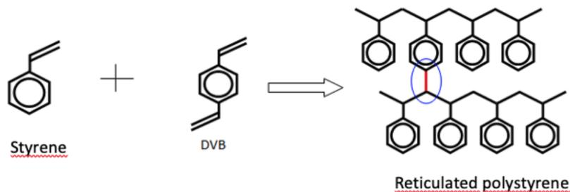
Das vernetzte Styrol-Divinylbenzol-Copolymer ist völlig unlöslich. Es bildet meistens das Skelett von Ionenaustauscherharzen oder Elektrodialysemembranen, bevor diese beschickt werden.
