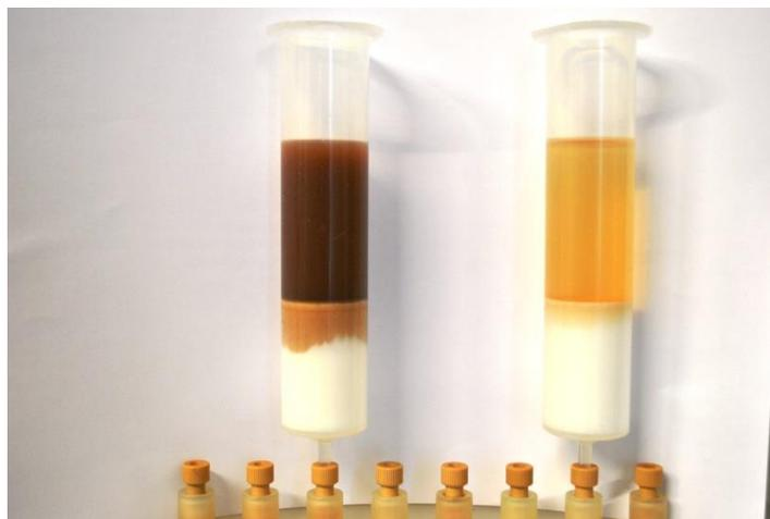
**Figura 1: Ejemplo de extracción por SPE**
