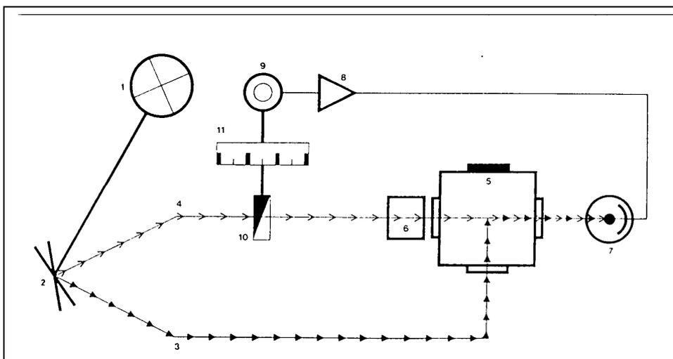
Une source lumineuse (1), alimentée par le secteur, envoie un faisceau lumineux sur le miroir oscillant (2) qui réfléchit, alternativement, un rayon de
